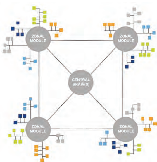
▲ 圖2：圖中的電子電氣分區架構顯示汽車功能在網路上的分散分佈
