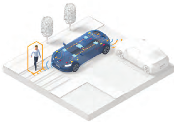
▲ 圖1：基於乙太網的車載網路傳輸功能安全關鍵資訊
